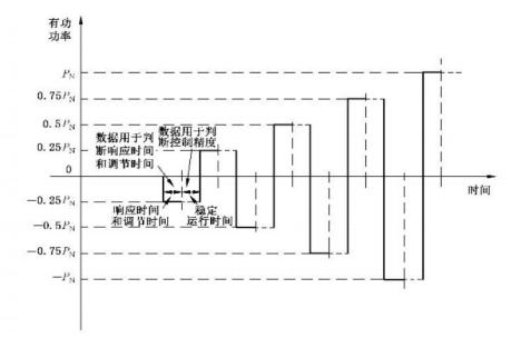
注1: 在相同的采样速率下,数据计算时间窗取 200 ms。
