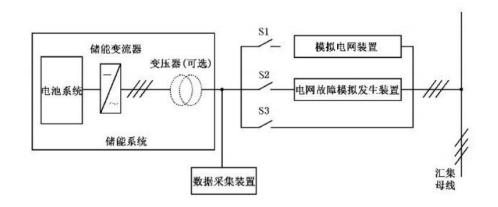
图 1 储能系统测试接线示意图
