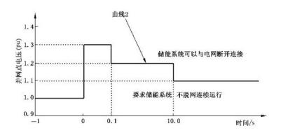
图 5 高电压穿越曲线
