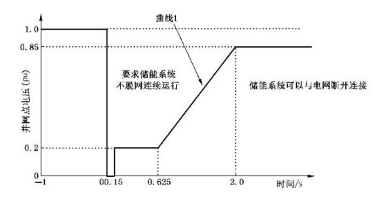
图 4 低电压穿越电线
